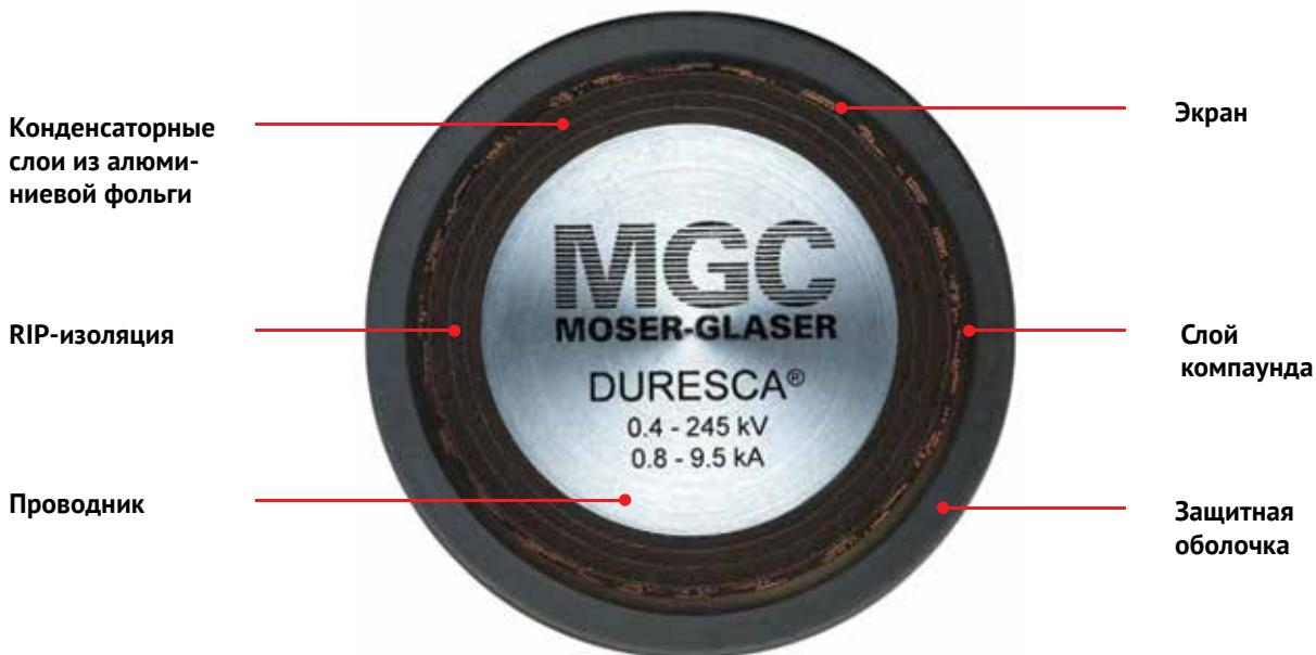
Инженерами завода Moser-Glaser была изобретена технология защиты RIP-изоляции токопровода с применением полиамидной трубы. Химический состав полиамида был разработан более 35 лет назад. За это время данная система защиты токопроводов отлично зарекомендовала себя.
